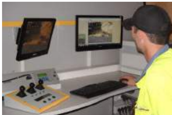
Exemple d'inspection télévisée avec véhicule spécialisé
